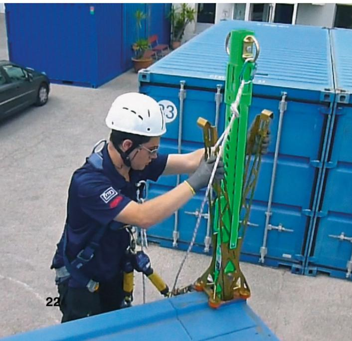
Der mobile Absturzsicherungsmast von 3M™ DBI-SALA® ist speziell für die Verwendung auf Maschinen, Transformatoren oder anderen vertikalen Plattformen mit Absturzrisiko konzipiert.
